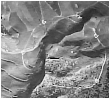
图 4 带等高控制点标记的实拍航空像片
